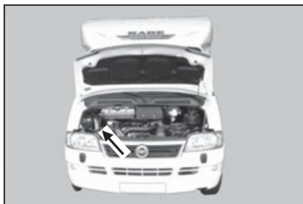
Latausvirran jakaja (R) on asennettu moottoritilaan.
