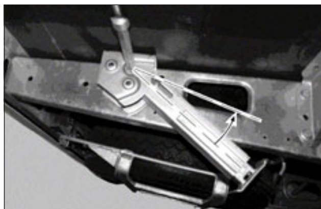
Tukijalka on veivattava perille saakka yläasentoonsa.
