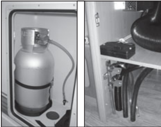
Kaasupullon päähana ja lämmittimen kaasuventtiili.
