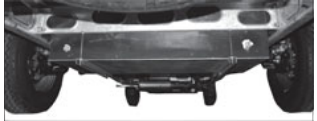
Harmaavesisäiliö on matkailuauton takapyörien välissä.
