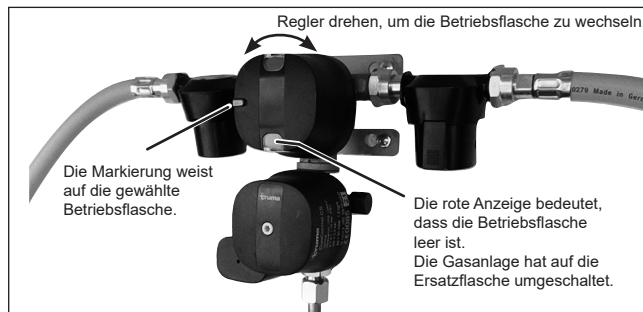
Truma DuoControl ist für zwei Gasflaschen vorgesehen.
