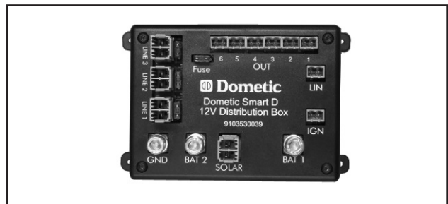
Väyläjärjestelmän yksikkö N1 on nimetty: Dometic Smart D 12V Distribution Box.
