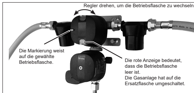
Truma DuoControl ist für zwei Gasflaschen vorgesehen.
