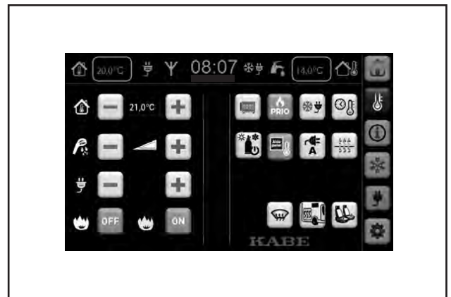
Bedientafel des Wohnmobils, Menü Heizung.
