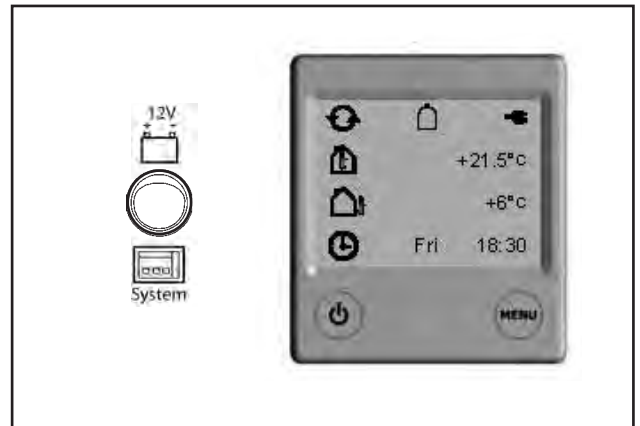
Bedientafel des Heizkessels.
