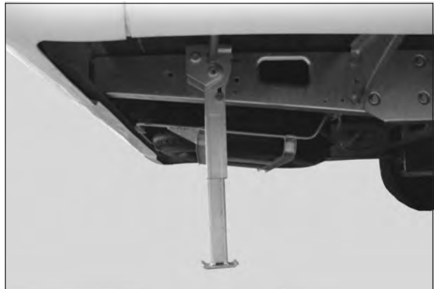
Herabgekurbelte Stütze zu Stabilisierung des Wohnmobils.
