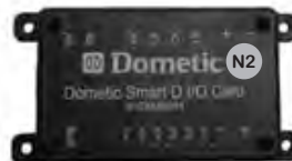
En av elsystemets enheter N2-N6. Dometic Smart D I/O Card.
