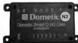
Een van de eenheden N2-N6 van het elektrische systeem. Dometic Smart D I/O Card.
