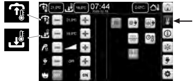
Vyöhykelämmitys: erilaiset lämpötilat istuinryhmässä ja makuuosassa.
