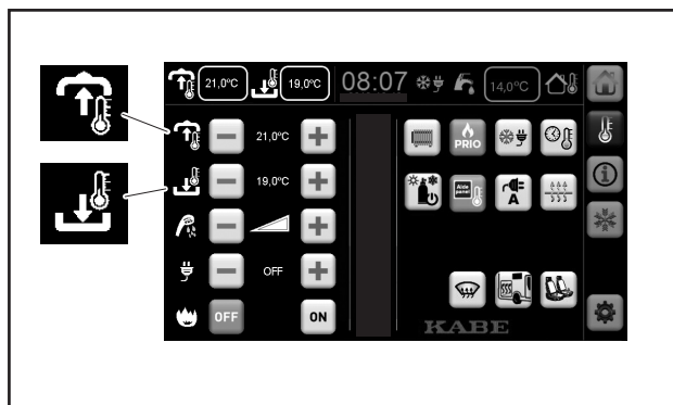
Zoneverwarming: verschillende temperaturen in zitgroep en slaapgedeelte.
