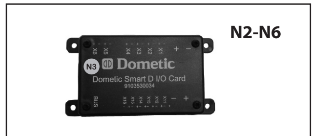
Op de afbeelding ziet u een van de eenheden N2-N6 van het elektriciteitssysteem: Dometic Smart D I/O Card.
