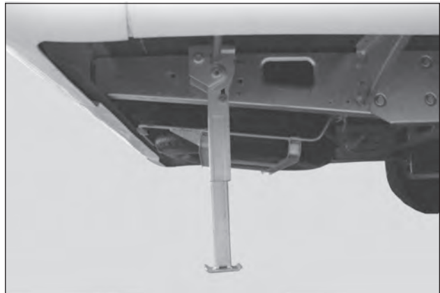
Herabgekurbelte Stütze zu Stabilisierung des Wohnmobils.
