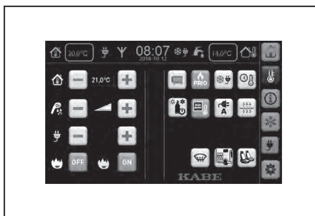
Bedientafel des Wohnmobils, Menü Heizung.
