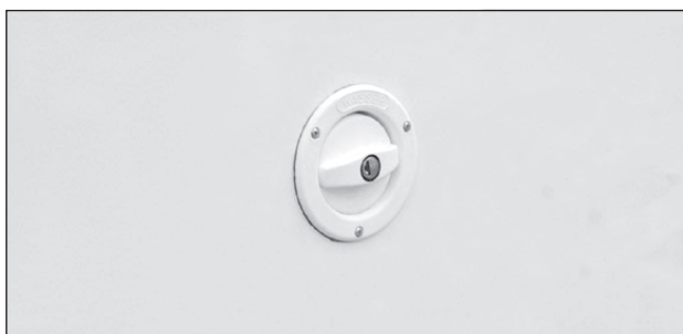
Nachfüllstutzen für Frischwasser.
