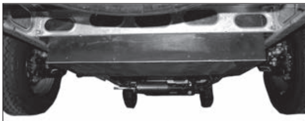
Gråvannstanken montert mellom bobilens bakhjul.
