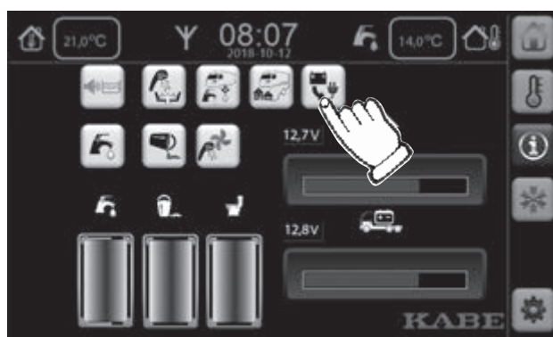
Slå inverteren på og av på betjeningspanelet.
