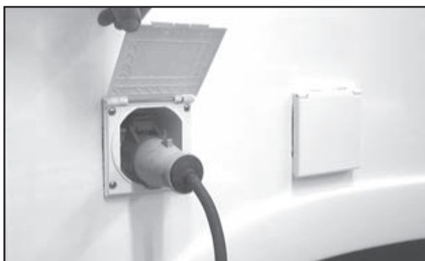
Oppvarming med elpatron forutsetter 230 V tilførsel.
