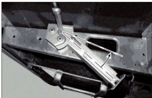
Støttebenet skal sveives helt opp til øvre stilling.
