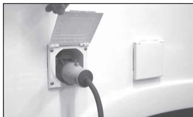
Aansluiting voor 230VAC.
