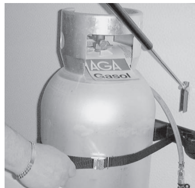
Kontroller at gassflasken er ordentlig festet.
