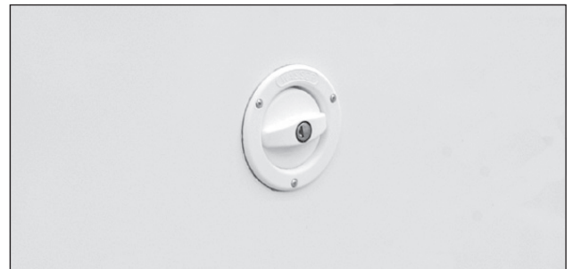
Nachfüllstutzen für Frischwasser.
