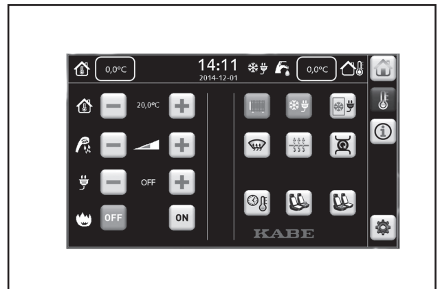
Bedientafel des Wohnmobils, Menü Heizung.
