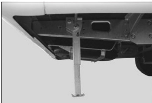
Støtteben sveivet ned for å stabilisere bobilen.
