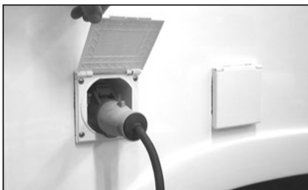
Oppvarming med elpatron forutsetter 230 V tilførsel.
