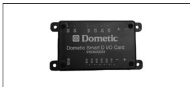
Väyläjärjestelmän asema 6 sähkötulolle ja -lähdölle.
