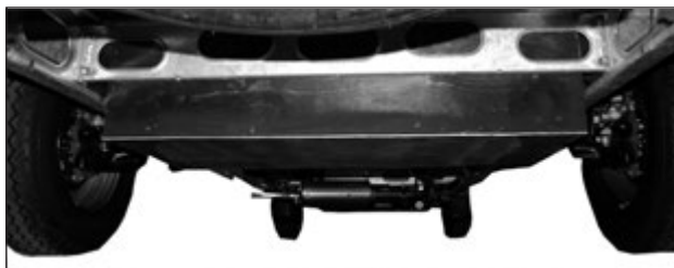
Harmaavesisäiliö on matkailuauton takapyörien välissä.
