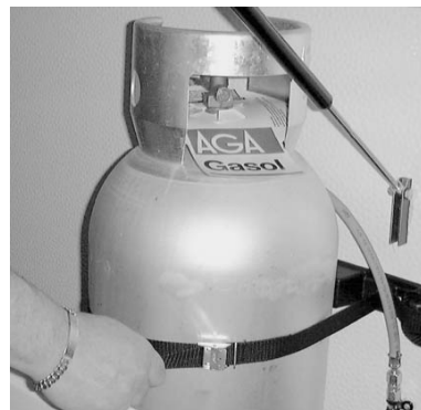
Sorgen Sie dafür, dass der Gasbehälter richtig festgespannt ist.
