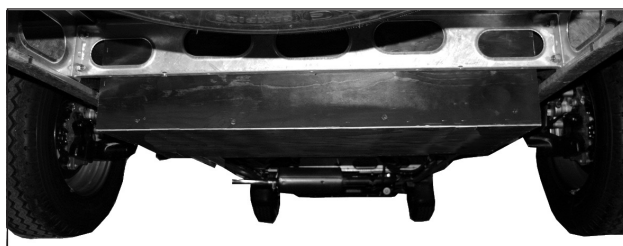
Harmaavesisäiliö on matkailuauton takapyörien välissä.
