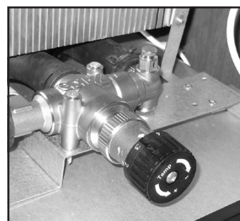
Shuntventil for gulvvarme (kun noen bobiler).
