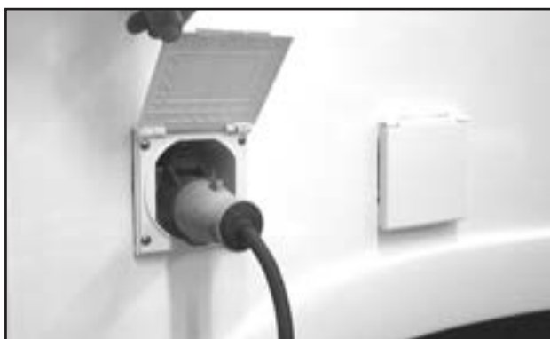
Uppvärmning med elpatron förutsätter 230V matning.
