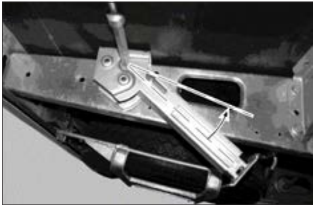
Tukijalka on veivattava perille saakka yläasentoonsa.
