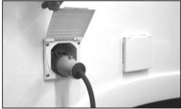
Liitântä 230VAC-järjestelmää varten.
