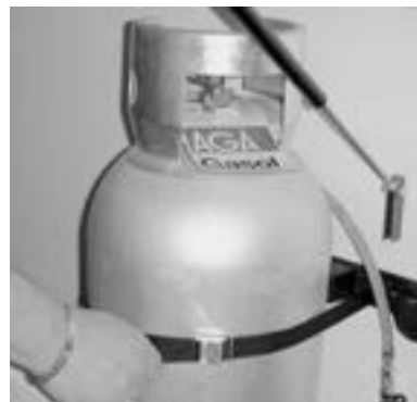
Tarkista huolellisesti, että kaasupullo on kunnolla kiinni.
