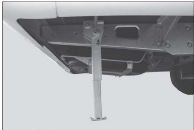
Herabgekurbelte Stütze zu Stabilisierung des Wohnmobils.
