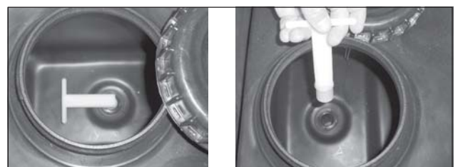
Grauwassertank-Entleerungspumpe und deren Schalter.
