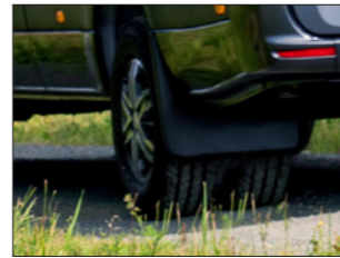
Dubbele wielen 4 x 2 en 4 x 4: 5 ton, ca 850 kg extra laadgewicht, combinatiegewicht 7 ton
