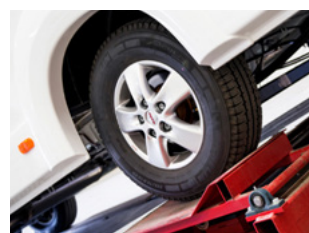
STERKTETEST TIJDENS HET RIJDEN Op een schudbank wordt de soliditeit getest, deze simulatie komt overeen met 100.000 km normaal rijden.
