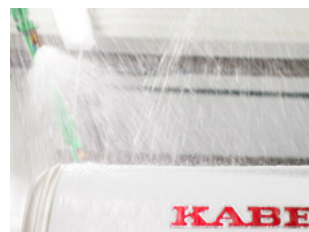
REGENKAMER In de regenkamer worden de campers onder hoge druk bespoten.
