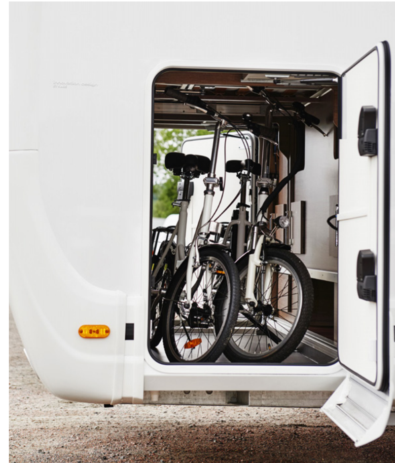
Praktische verankeringslussen op de rails van de garage zorgt ervoor dat alles op zijn plaats blijft.
