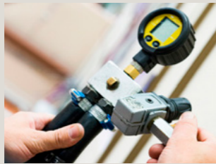
GASSYSTEEM Het flessengassysteem wordt onder druk getest.
