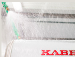
REGENKAMER In de regenkamer worden de campers onder hoge druk bespoten.
