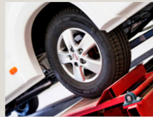
STERKTETEST TIJDENS HET RIJDEN Op een schudbank wordt de soliditeit getest, deze simulatie komt overeen met 100.000 km normaal rijden.
