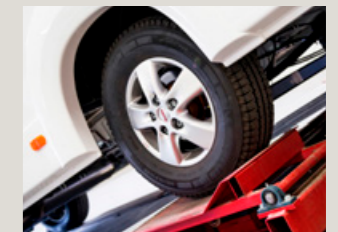
HÅLLBARHETSTEST KÖRNING. Hållbarhetstest simuleras i en skakbänk motsvarande 10 000 mil normal körning.
