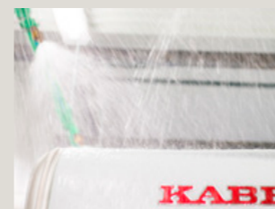
REGNKAMMER. I regnkammeret sprutes det vann på bobilene under høyt trykk.
