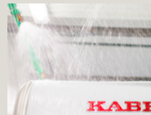
SADEKAMMIO. Sadekammiossa matkailuautojen päälle ruiskutetaan vettä kovalla paineella.
