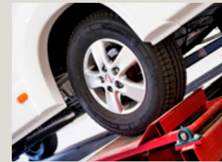
KESTÄVYYSTESTI VEDETTÄESSÄ. Kestävyyttä simuloidaan tärityspenkissä kokeessa, joka vastaa 100 000 kilometrin normaalia ajoa.
