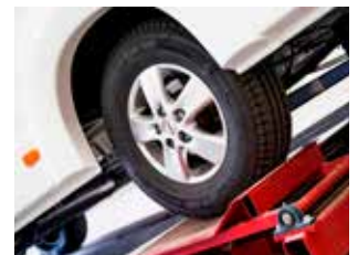
Holdbarhetstest kjøring. Holdbarhetstest simuleres i en vibrasjonsbenk og tilsvarer 10 000 mil normal kjøring.
