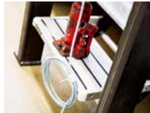
Holdfastheten. Trykk benyttes for å teste produktene holdfasthet.
