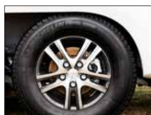
Aluminium velg 16" (standaard i810, i860, i910) incl. 4 originele stalen velgen en wieldeksels
