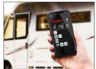
KABE Smart D Remote. KABE Smart D Remote maakt het mogelijk om het bedieningspaneel van de camper op afstand te besturen, waar u zich ook bevindt, via een app in uw smartphone. Het systeem is opgebouwd rond een 4G-router met externe antennes en een mobiel modem. Behalve dat u via de telefoon verwarming en verlichting kunt regelen en de functies en de alarminstallatie van de camper kunt bewaken, heeft u onderweg ook nog toegang tot uitstekend draadloos internet.
