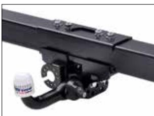
Trekhaak (max. sleepgewicht 2000 kg) Fiat combinatiegewicht: 6000 kg MB combinatiegewicht: 5880 kg
