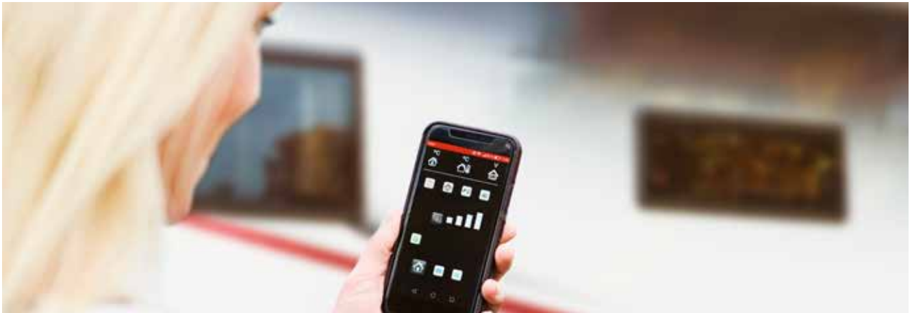
KABE Smart D Remote. KABE Smart D Remote mahdollistaa matkailuauton käyttöpaneelin kauko-ohjauksen kaikkialta älypuhelimien sovelluksella. Se toimii ulkoantenneilla varustetulla 4G-reitittimellä ja modeemilla. Sen lisäksi, että voit ohjata lämmitystä ja valaistusta, ja valvoa matkailuauton toimintoja ja hälytyksiä puhelimen välityksellä, saat matkalle myös todella hyvän langattoman internetyhteyden.
