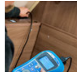
Sähköjärjestelmät ja muut tärkeät toiminnot tarkastetaan, ennen kuin matkailuautot toimitetaan tehtaalle.
