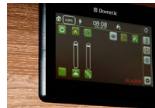
Aloitussivulla näytetään kaikki valopainikkeet ja digitaaliset himmennysäätitimet. Täältä näet myös ulko- ja sisälämpötilan sekä kellon.
