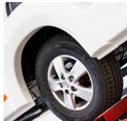
Kestävyyttä simuloidaan täristyspenkissä kokeessa, joka vastaa 100 000 kilometrin normaalia ajoa.
