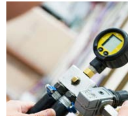
Kaasujärjestelmälle tehdään painekoe.
