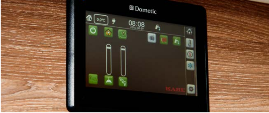
Aloitussivulla näytetään kaikki valopainikkeet ja digitaaliset himmennysäätitimet. Täältä näet myös ulko- ja sisälämpötilan sekä kellon.
