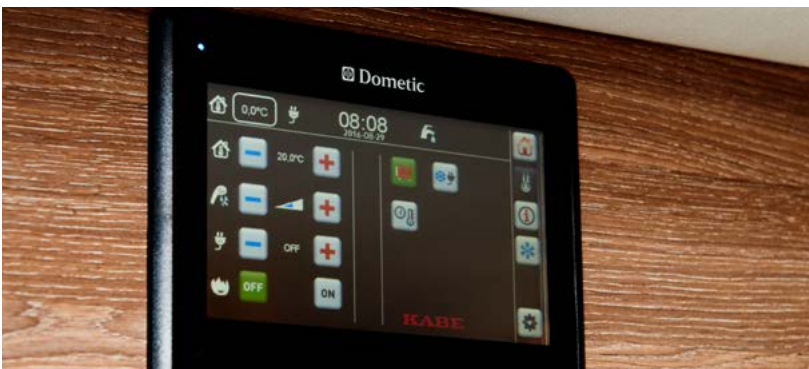
Kaikki lämmitystiedot ja -säädöt näytetään omalla sivullaan. Täältä nostat ja lasket lämpöä kätevästi digitaalisilla liukusäätimillä.
