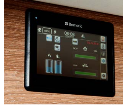
Tuore- ja harmaaveden tasot ja akkujännite näytetään havainnollisella tavalla.
