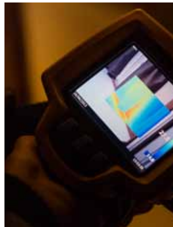
Met behulp van warmtecamera's zorgen wij ervoor dat de constructie exact de gewenste kwaliteitswaarden heeft.
