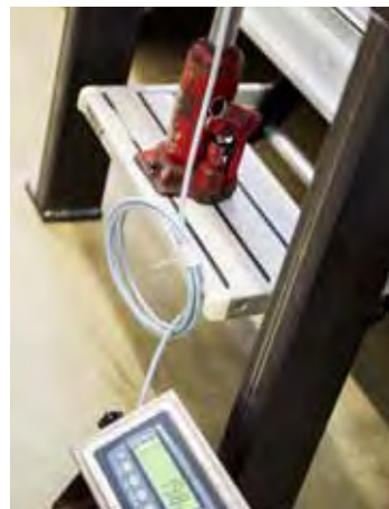
Met behulp van druk wordt de sterkte van de producten getest.
