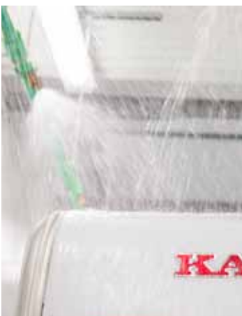
Sadekammiossa matkailuautojen päälle ruiskutetaan vettä kovalla paineella.
