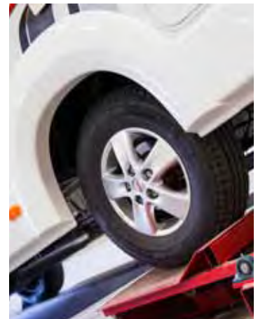
Kestävyyttä simuloidaan täristyspenkissä kokeessa, joka vastaa 100 000 kilometrin normaalia ajoa.
