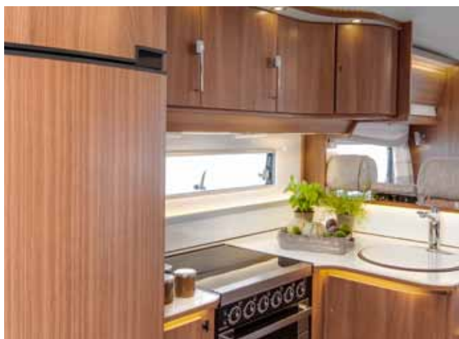
Det helautomatiska kylskåpet med AES växlar på egen hand mellan 230 V, 12 V och gasol beroende på tillgång.
