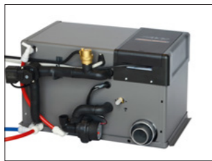
Alde Flow in ketel 3030 Plus. Met Alde Flow kunt u warm douchen zolang u maar wilt! Alde Flow is een aparte warmwatertank die wordt aangesloten op het glycol-verwarmingssysteem. De tank verwarmt vers water voordat het de gewone warmwatertank van de verwarmingsketel bereikt en zorgt voor permanent warm water in de kranen.
