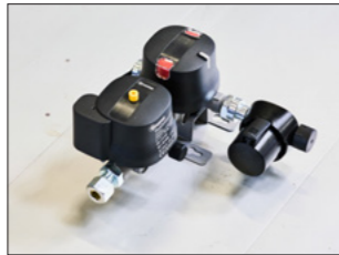
Duo Control. Duo Control heeft een ingebouwde automatische gas-omschakelaar, een reductieklep en een botsensor die wordt geactiveerd bij een botsing met een G-kracht van 3,5 G. De aanvoer van flessengas wordt dan direct onderbroken om gaslekkage te voorkomen. Duo Control is in heel Europa goedgekeurd zodat het flessengas tijdens het rijden gebruikt mag worden.
