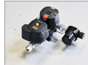
Duo Control. Duo Control heeft een ingebouwde automatische gas-omschakelaar, een reductieklep en een botsensor die wordt geactiveerd bij een botsing met een G-kracht van 3,5 G. De aanvoer van flessengas wordt dan direct onderbroken om gaslekage te voorkomen. Duo Control is in heel Europa goedgekeurd zodat het flessengas tijdens het rijden gebruikt mag worden.
