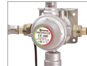
Duo Control. Duo Control hat einen eingebauten, automatischen Gas-schalter, ein Reduktionsventil und einen Aufprallsensor, der bei einem Aufprall mit einer G-Kraft von 3,5 G auslöst und die Gasversorgung unterbricht, um das Ausströmen von Gas zu verhindern. Duo Control ist in ganz Europa zugelassen und erlaubt den Gasbetrieb während der Fahrt.
