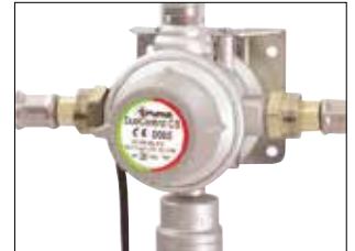
Duo Control. Duo Control hat einen eingebauten, automatischen Gas-schalter, ein Reduktionsventil und einen Aufprallsensor, der bei einem Aufprall mit einer G-Kraft von 3,5 G auslöst und die Gasversorgung unterbricht, um das Ausströmen von Gas zu verhindern. Duo Control ist in ganz Europa zugelassen und erlaubt den Gasbetrieb während der Fahrt.
