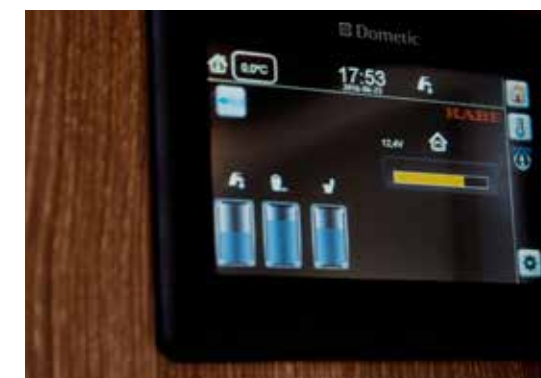
Aktuell statusinformasjon om ferskvannsnivå, spillvannsnivå og batterikapasitet vises på en oversiktlig måte.
