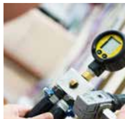
Gassystem. Gassystemet trykktestes.
