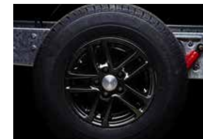
Dekkene og koblingen. Dekk på enkelakslede vogner er av typen 8-lags dekk. Boggivogner har 14" lavprofildekk. Alle vogner har friksjonskobling.
