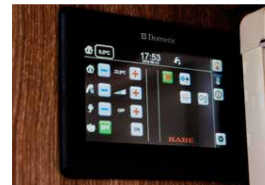
All informasjon og styring angående varme vises på en egen side. Her hever og senker du varmen smidig med digitale skyvebrytere.
