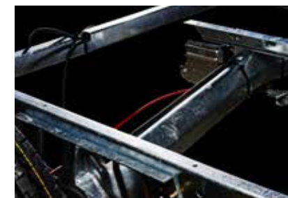
Ekstra vridningsstivt chassis. Ekstra bjelker mellom langsgående chassisrammer gir stabilere gulv og ekstra vridningsstivt chassis. Mellombjelker for beste stabilitet. Chassiset har utstikkere fra langsgående sidebjelke for å avlaste fra tyngden der gulv og vegg er sammenføyd. Karosseriet tåler veldig høy belastning, for eksempel når store mengder snø ligger på taket.
