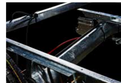
Chassis med ekstra vridstivhed. Ekstra tværvange mellem langsgående vanger giver et mere stabilt gulv og et chassis med ekstra vridstivhed. Tværvanger for bedste stabilitet. Chassiset har udliggere fra den længdeforløbende sidevange som aflastning for vægten, hvor gulv og væg er samlet. Karosseriet kan tåle en meget høj belastning, for eksempel når der ligger store mængder sne på taget.
