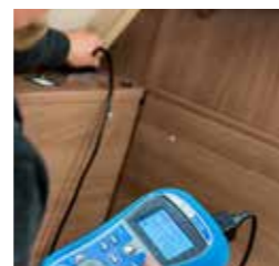
Elsystemer. Elsystemet og andre vigtige funktioner kontrolleres inden campingvognene og autocampere får lov til at forlade fabrikken.
