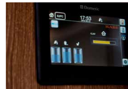
Aktuel statusinformation om ferskvandsniveau, spildevandsniveau og batterikapacitet vises på en overskuelig måde.
