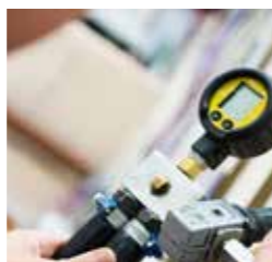
Gassystemet. Gasflaskesystemet tryktestes.
