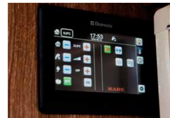
Al information og styring omkring varme vises på en side for sig. Her skrues du nemt og praktisk op og ned for varmen med digitale knapper.
