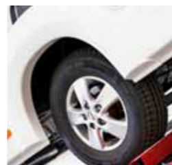
Slidstyrketest kørsel. Holdbarhedstests simuleres på et rystebord, der svarer til 100.000 km normal kørsel.
