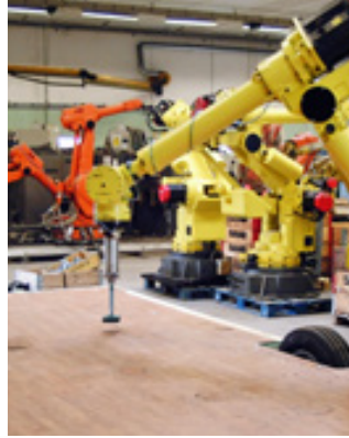
Utholdenhetstester gjøres på de ulike delene av karosseriet.
