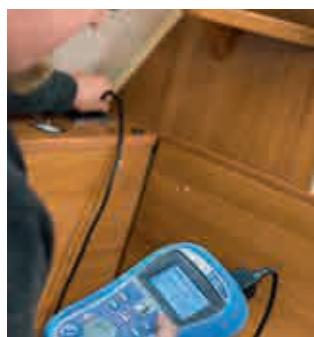
Elsystemet og andre viktige funksjoner kontrolleres før campingvognene og bobilene får forlate fabrikk.
