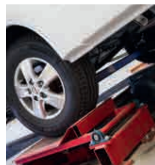
Holdbarhetstest simuleres i en vibrasjonsbenk og tilsvarer 10 000 mil normal kjøring.
