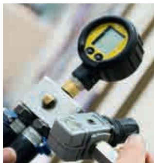
Het flessengassysteem wordt onder druk getest.
