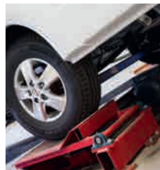
Op een schudbank wordt de soliditeit getest, deze simulatie komt overeen met 100.000 km normaal rijden.
