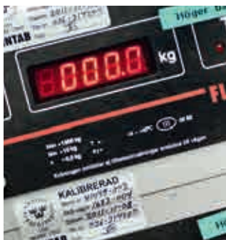
Weegschalen voor het balanceren en optimaliseren van de gewichtsverdeling over de assen.
