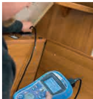
Het elektrische systeem en andere belangrijke functies worden gecontroleerd voordat de caravans onze fabriek verlaten.
