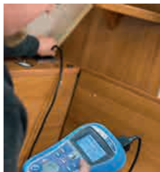
Elsystemet og andre vigtige funktioner kontrolleres inden campingvognene og autocampere får lov til at forlade fabrikken.
