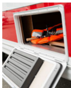
Serviceklap med luftkanaler på alle modeller
