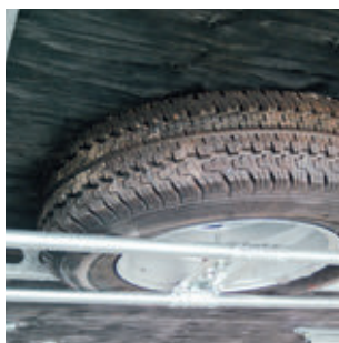
ERSATZRADHALTER ALKO MONOACHSE (X0289) DOPPELACHSE (X0063) (STD. IM DEUTSCHLAND)
