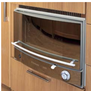
Backofen mit Grill Grill oben im Backofen. Der Ofen hat Innenbeleuchtung, Doppelglastür und Kindersicherung und wird mit Ofenblech und Grillrost geliefert. Inhalt: 20 l. Für Montage in Küchenunter- oder Oberschrank.
