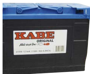
Große Batterie 115 A einschl. Batteriekasten (Serienmäßig in Deutschland).
