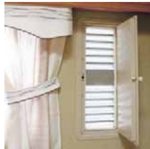
Zusätzliche Lüftungsluke (X0047) Für das schnelle Lüften des Wohnwagens ist eine Lüftungsluke die beste Alternative. (Alle Wohnwagen haben eine Luke serienmäßig).
