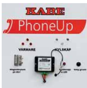
Phone Up GSM- Alarm über das Mobiltelefon. Steuerung von Heizung und Kühlschränken. Überwachung von Eingangstür, Spannung und Temperatur.
