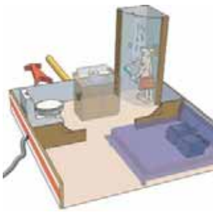
Anschluss an kommunales Wasser-/Abwassernetz Das Abwasser von Küche und Waschraum fließt zuerst durch den Kassetank der Toilette, bevor es mittels einer Pumpe mit eingebauter „Mühle“ in die Kanalisation des Campingplatzes eingeleitet wird.
