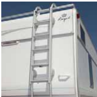
Dachreling mit Klappleiter (X0150) Klässt sich mit einem Fahrradhalter kombinieren. Zwischenstrebe für Dachständer (X0158)
